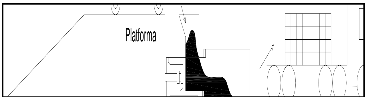
Слика 36 - Принцип рада на трансфер станици - платформа за истовар са навозом
