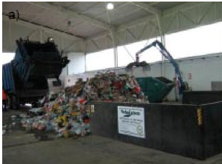
Слика 9 - Истовар отпада у прихватну комору постројења за сепарацију
