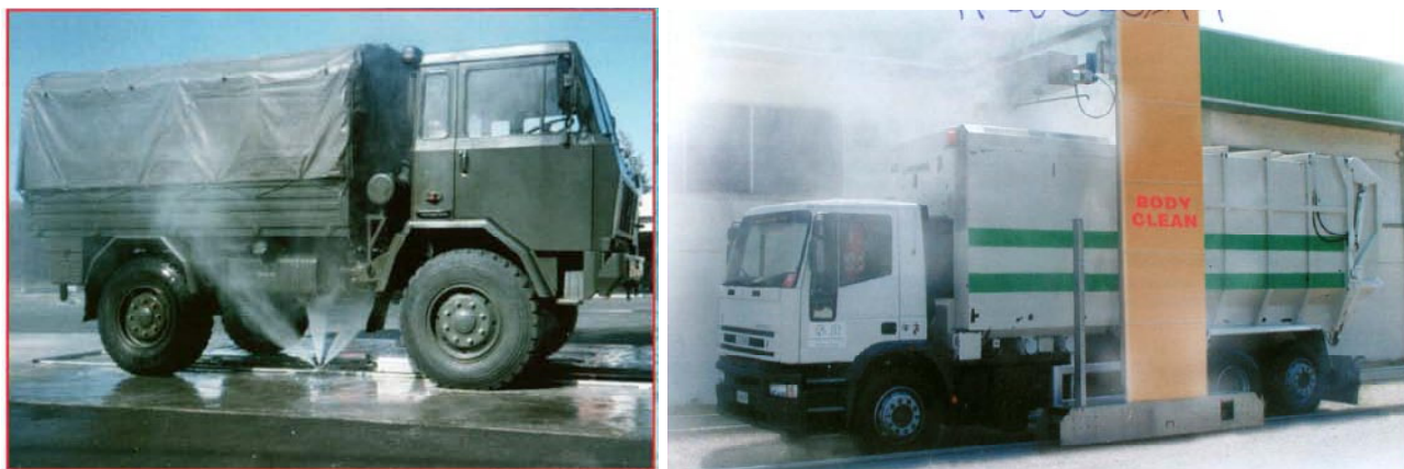
Слика 41 - Уређаји за прање доњог построја (Chassis clean) и целог возила (Body clean)
