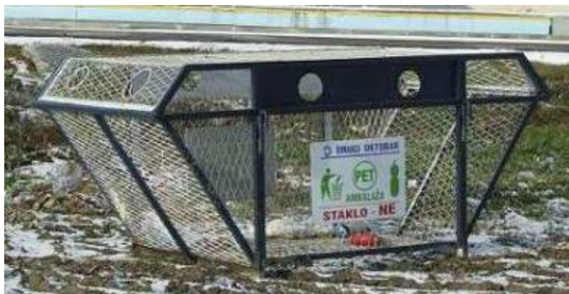
Слика 22 - Жичани контејнер за сакупљање отпадног ПЕТ-а (тип контејнера запремине 3 м 3 )
