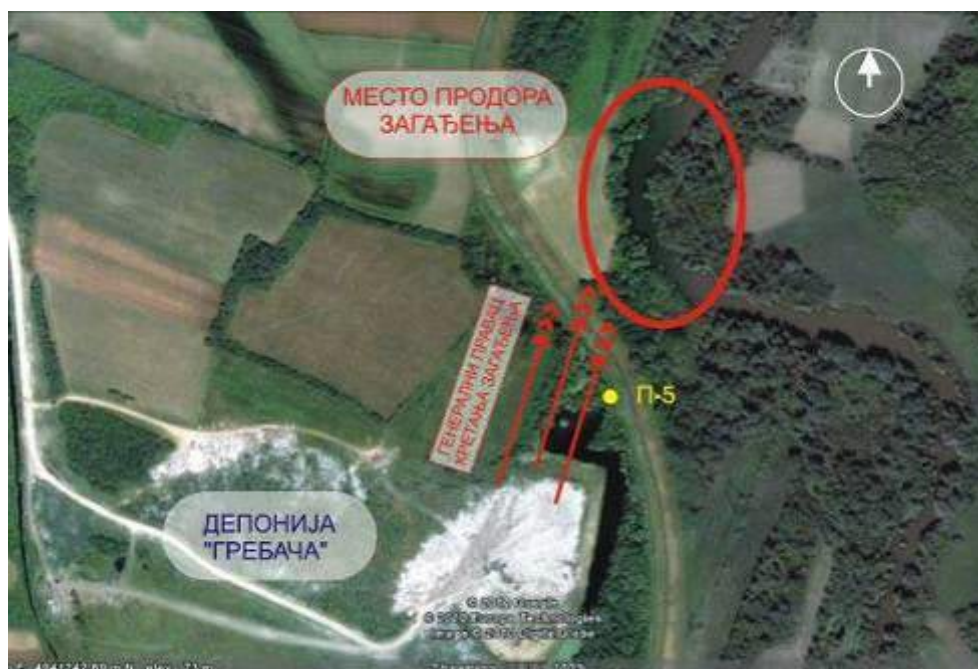
Слика 2 - Сателитски снимак загађења Колубаре проузрокованог процедурним водама са градске депоније "Гребача"
